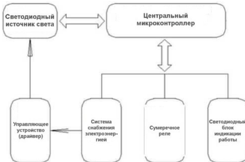
Рисунок 4. Принципиальная схема работы заградительного огня.
